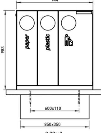
Rozměry výrobků mají informativní charakter. Výrobce si vyhrazuje právo na změnu technické specifikace bez předchozího upozornění. Rozměry spodní stavby a způsob osazení výrobku jsou závazné. Rozteč kotev rozměrovat dle rozměrů dodaného výrobku.
