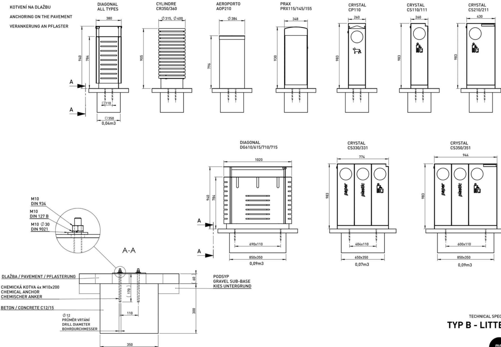
Rozměry výrobků mají informativní charakter. Výrobce si vyhrazuje právo na změnu technické specifikace bez předchozího upozornění. Rozměry spodní stavby a způsob osazení výrobku jsou závazné. Rozteče kotev rozuměvat dle rozměrů dodaného výrobku.
