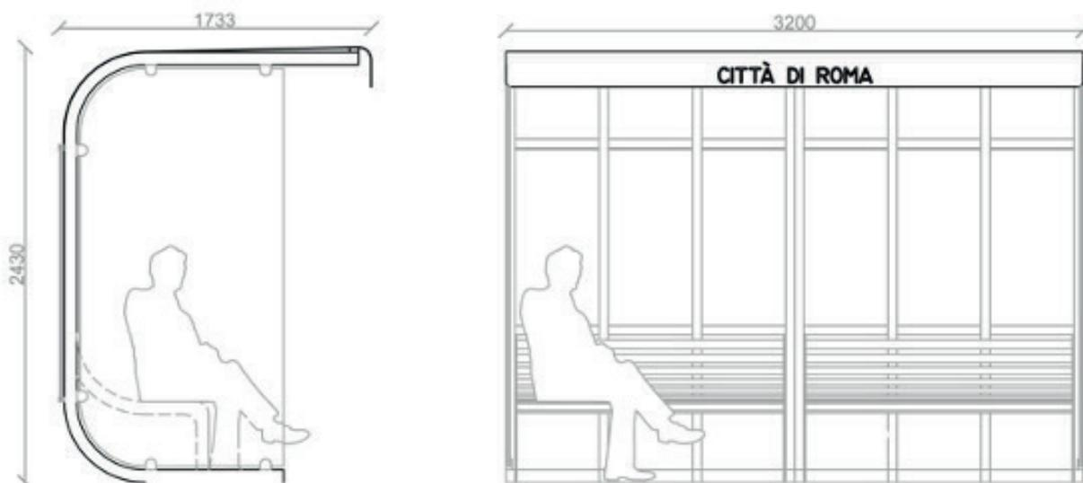
DOLCEVITA è una pensilina modulare composta da una struttura formata da 4 profili tubolari in acciaio di dimensioni 60x40 mm, opportunamente calandrati che diventano sistema di ancoraggio a terra e sistema di copertura. Una orditura trasversale di profili tubolari in acciaio sempre di dimensioni 60 x 40 mm stabilizza l'intera pensilina. L'elemento di copertura è ottenuto grazie ad una sottile lamina di acciaio ancorata ai tubolari strutturali che, nella parte anteriore diventa
