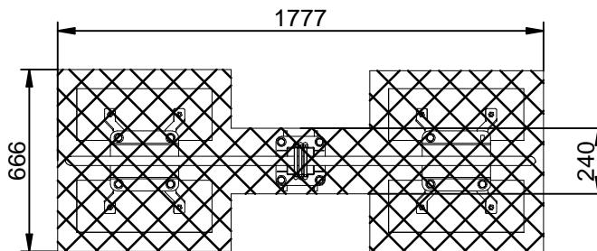
Detalles de la cimentación necesaria en condiciones normales (debería tenerse cuidado en lo referente a las condiciones anormales).
