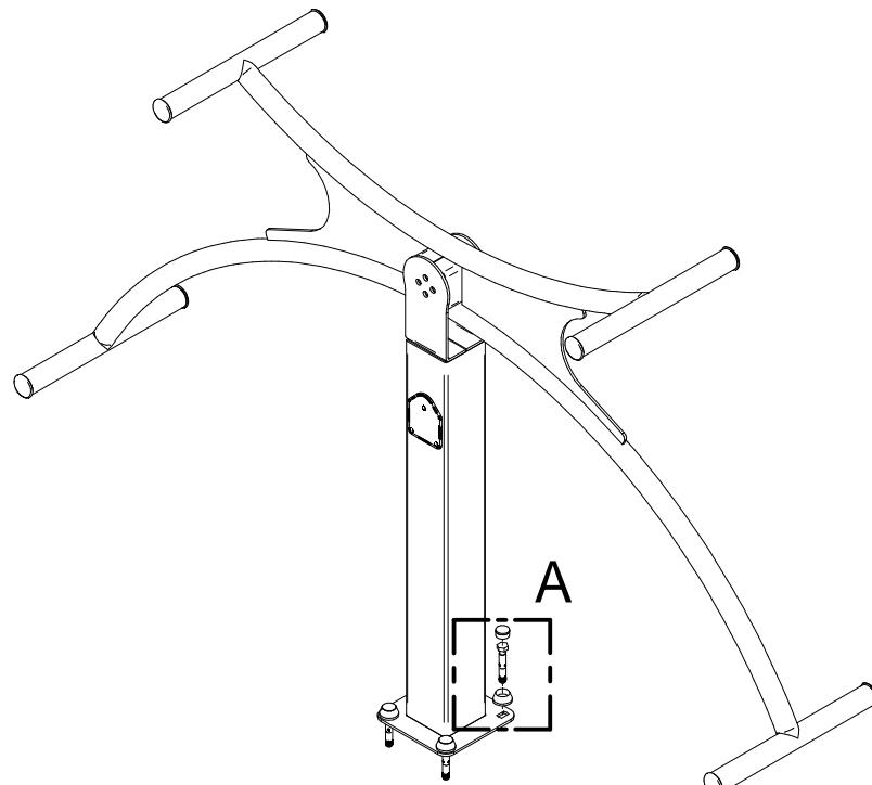
Detalles de la cimentación necesaria en condiciones normales (debería tenerse cuidado en lo referente a las condiciones anormales).
