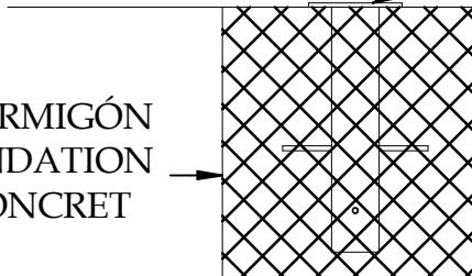
La brida del acople debe quedar por fuera del hormigón
