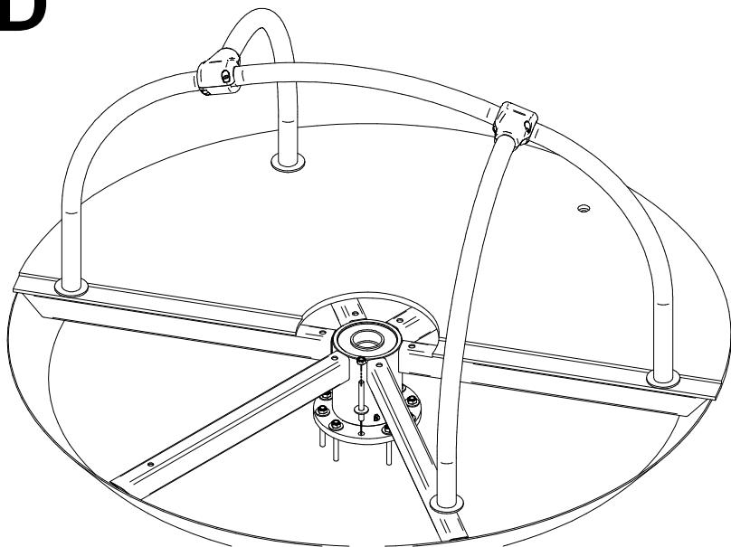
**IMPORTANTE:** Hay que fijar la varilla con CEMENTO EPOXI
