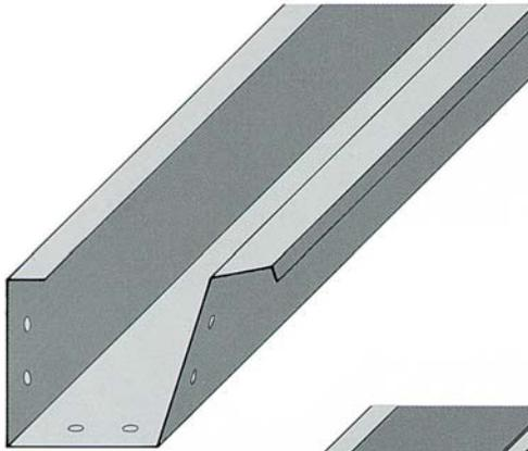
**TYPICAL BOUNDARY WALL BOX GUTTER**
